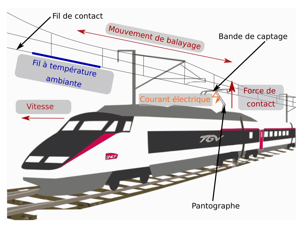
Schéma d'une liaison caténaire pantographe
