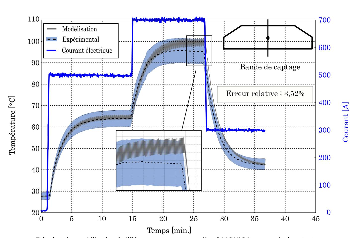
Résultat de modélisation à différents courants avec l'outil MONICA comparée à un test expérimental (tirée de la thèse de N. DELCEY)
