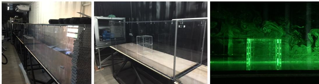
Banc expérimental disponible au laboratoire PIMENT. A gauche le tunnel à vent, au milieu une configuration à échelle réduite de bâtiment à 1 étage et à droite une visualisation Laser pour suivre les fumées.
